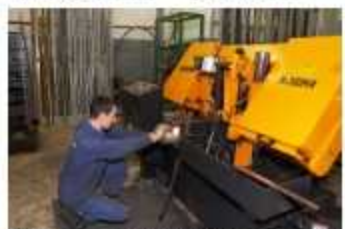
Замена режущей ленты на участке 37
